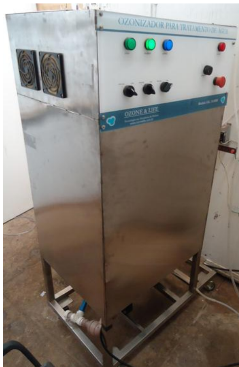
Figura 5. Gerador de ozônio modelo O&L 10.0RM
