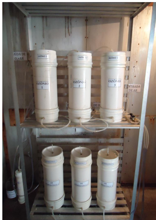
Figura 3. Câmaras de fumigação utilizadas para os tratamentos com o gás ozônio e ar atmosférico.
