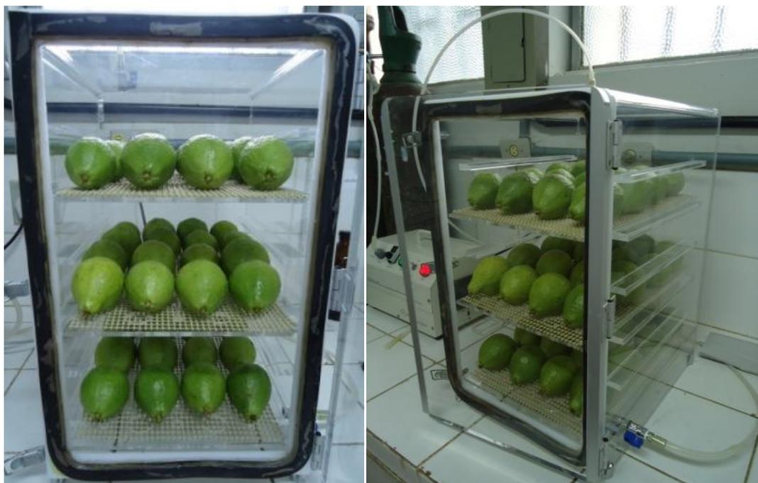
Figura 4 – Câmara de fumigação desenvolvida e confeccionada em material acrílico com sistema de vedação por meio de perfis de silicone e fechos rápidos, com capacidade de 60 L, podendo comportar até 48 frutos de goiaba.
